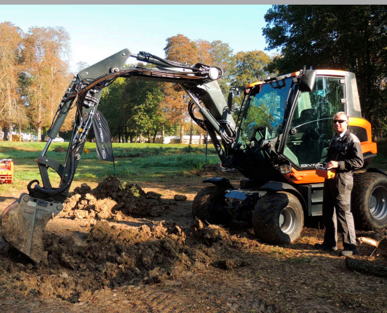
Der Multifunktionsbagger kann auch per Fernsteuerung bedient werden.
