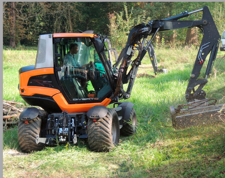
Diverto QS 100 als Mobilbagger mit Anbaugerät „Schlegelmähwerk“.
