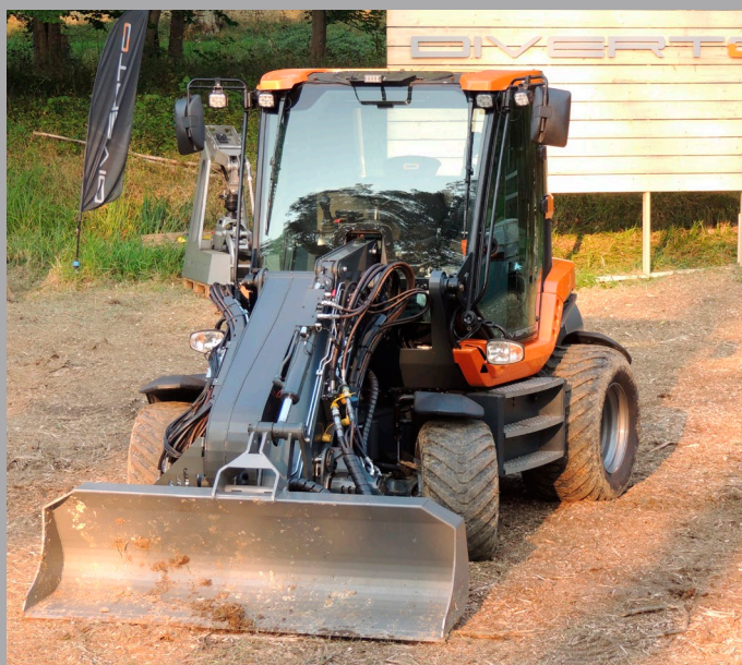
Diverto QS 100, die Ausleger hier in der Stellung als Radlader.
