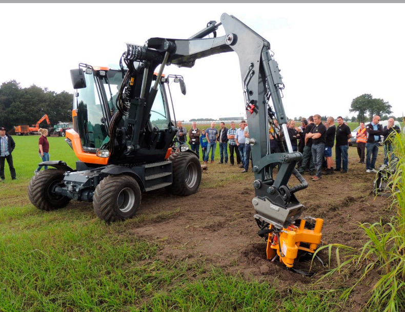
Diverto QS 100 als Mobilbagger mit Schnellwechseleinrichtung.
