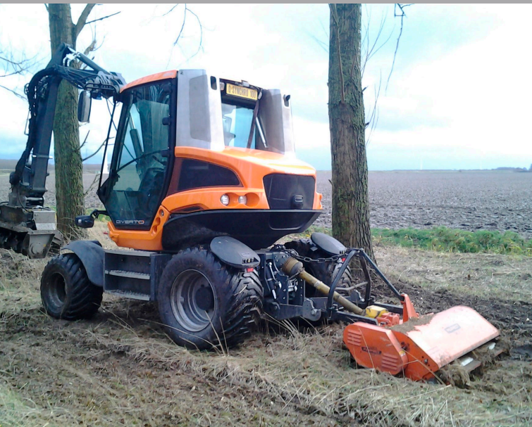
Heckansicht mit einem Mulcher am Kraftheber, Zapfwelle, Zusatzhydraulik, Anhängervorrichtung
