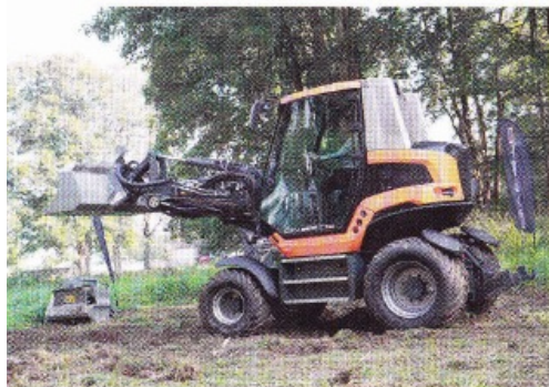
Le bras se replie en moins d'une minute pour passer en mode chargeuse.
