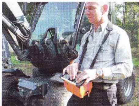
Le QS 100 peut être entièrement piloté à distance via une radiocommande.
