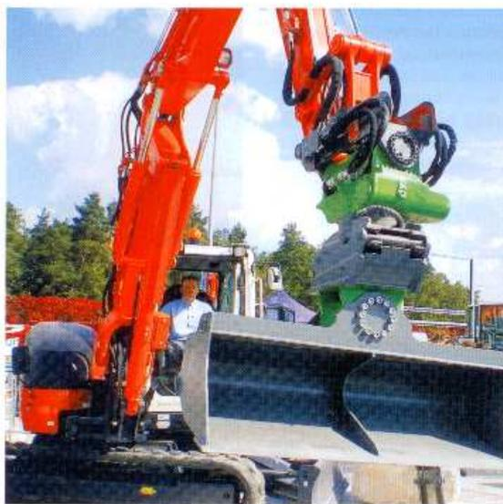
Mit dem TiltRotator bis zu 180° schwenken oder links und rechts herum endlos rotieren.
