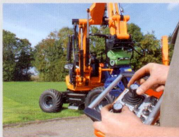
De kraan is met een afstandsbediening te besturen. Met een versnippelaar in de hef kun je dan tegelijk hout hierin invoeren.
