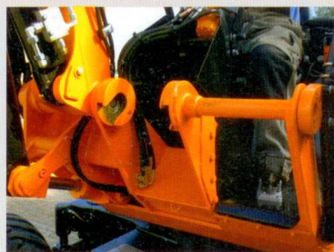
In shovelstand zijn de giekdelen mechanisch hydraulisch vergrendeld met een dikke pen. De krachten zijn zo naar één frame geleid.
