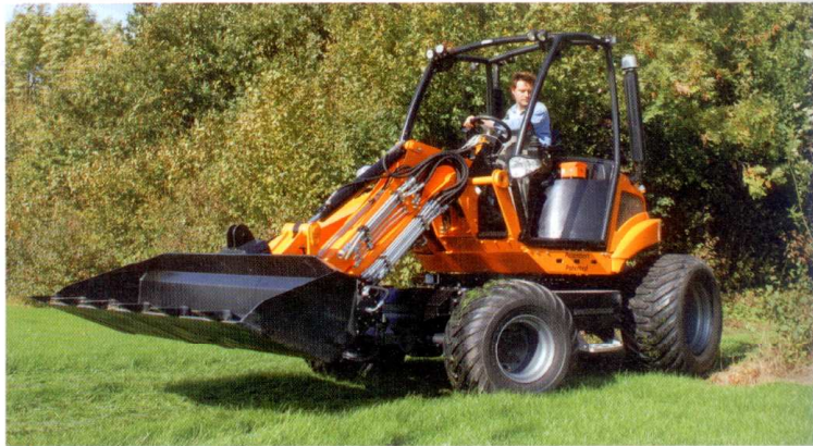
De Q Synchro omgetoverd tot shovel. De driedelige giek is opgevouwen tot een massieve laadschop-arm. Hiermee is 1.700 kg te tillen en tot 2,80 meter. De uitbreekkracht is ongeveer 2 ton.
