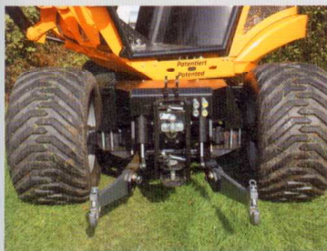
De hef tilt 2 ton. Er zijn een 540/1.000 aftakas en twee extra hydraulische functies. De achterwielen zijn groter dan de voorwielen.
