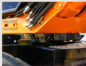
In shovelstand kun je de bovenbouw blokkeren. Dit gebeurt via een mechanisch hydraulische blokkering van de draaikrans.
