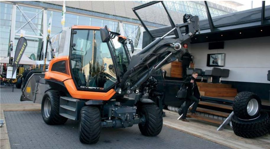
Als Radlader (hier ohne Schaufel) und heckseitigem Shredder – gut erkennbar sind das Mitschwenken des Hubgerüsts mit dem Oberwagen und die rechte Kabinentür.
