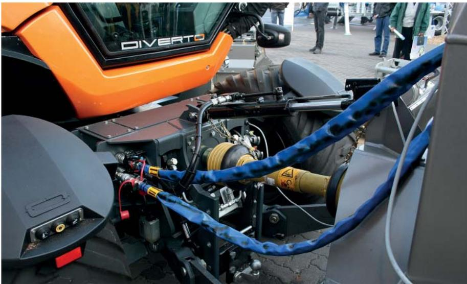
Heckansicht mit Kraftheber, Zapfwelle, Zusatzhydraulik, Anhängerzugvorrichtung.
